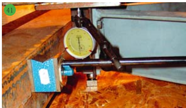
Měření průhybů podlahy
